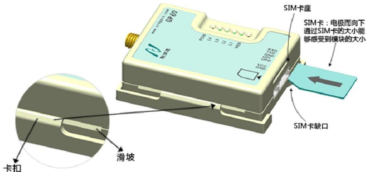
**注意：**插拔 SIM 卡时请先将电源断开。以免损坏 GP60 模块和 SIM 卡。
